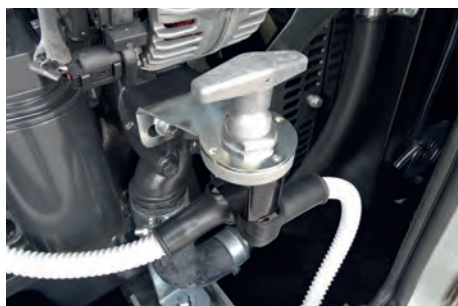
Stacca batteria Battery isolator switch Interrupteur batterie
