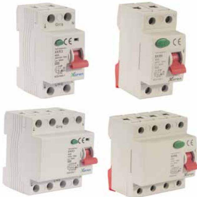
3kA, 6kA ve 10kA, 30mA ve 300mA olarak ürettiğimiz Kaçak Akım Koruma Şalterleri, bir kişiyi hatalı kablolama veya toprak arızalarından kaynaklanan elektrik çarpması ve yangın risklerinden korumayı amaçlar. Elektrik kaçak akımlarını algılamak ve bu akımlara karşı koruma sağlamak için en güvenli cihazdır.
