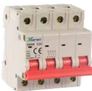
1A'dan 125A'ya kadar 3kA, 6kA ve 10kA kesme kapasitesine sahip olan otomatik sigortalar, bağlı bulundukları devreyi aşırı yük ve kısa devrelerle karşı koruyan, aynı zamanda devreyi açma ve kapama fonksiyonunu da yerine getiren cihazlardır.
