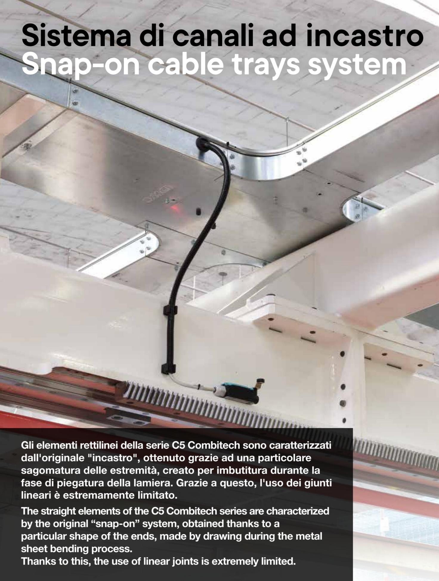
Gli elementi rettilinei della serie C5 Combitech sono caratterizzati dall'originale "incastro", ottenuto grazie ad una particolare sagomatura delle estremità, creato per imbutitura durante la fase di piegatura della lamiera. Grazie a questo, l'uso dei giunti lineari è estremamente limitato.
