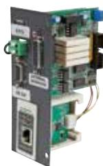
L'agente di Rete interno SNMP SOLO e TRIO consente la gestione degli UPS della serie SOLO e TRIO collegati direttamente sulla rete LAN 10/100 Mb utilizzando i principali protocolli di comunicazione di rete (TCP/IP , http, SNMP). Una volta configurato l'indirizzo di rete della macchina è possibile utilizzare il software di gestione per il controllo in tempo reale e l'impostazione delle principali funzioni di teleassistenza.
