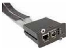
L'agente di Rete interno SNMP SML\_C consente la gestione degli UPS della serie SMALL C collegati direttamente sulla rete LAN 10/100 Mb utilizzando i principali protocolli di comunicazione di rete (TCP/IP, http, SNMP). Una volta configurato l'indirizzo di rete della macchina è possibile utilizzare il software di gestione per il controllo in tempo reale e l'impostazione delle principali funzioni di teleassistenza.
